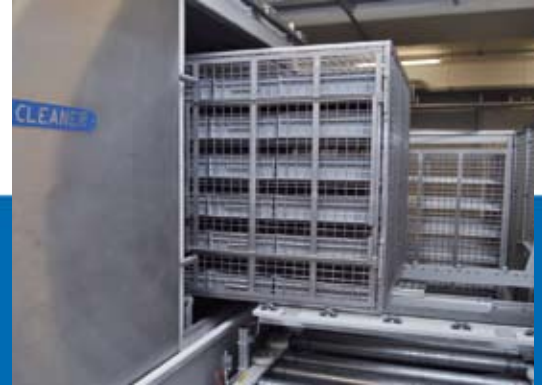
Teil der Lösung ist eine automatische Zuführung. Während der volle vordere Korb zentriert, angehoben und in den Reinigungsraum der Bupi-Anlage gebracht wird, steht der hintere zur Bestückung bereit.
