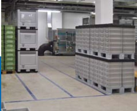
Für den Transport der Teile werden Gebinde unterschiedlicher Größen eingesetzt. Um die Restschmutzanforderung einzuhalten, müssen sie sauber und ölfrei sein.
