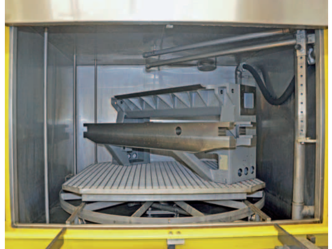
Der Reibradantrieb gewährleistet eine gleichmäßige Drehung des Waschguts während des Reinigungsvorgangs.
