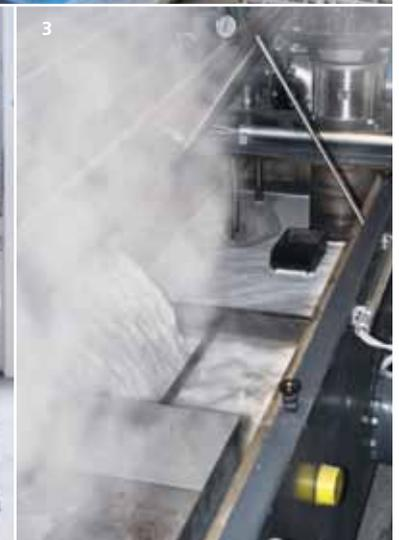
die Reinigungsmittelrückstände mittels Druckluftpistolen weg blasen, wollte sich LBH speziell bei den Ventilatoren nicht auf solche Methoden verlassen. Die Anlage ist daher mit einer Druckluft-Membranpumpe ausgestattet, die eventuelle Flüssigkeitsreste in den Reinigungsmittelbehälter zurück fördert. Diese sorgt auch dafür, dass kein austretender Wasserdampf das Klima in der Werkshalle beeinflusst.
