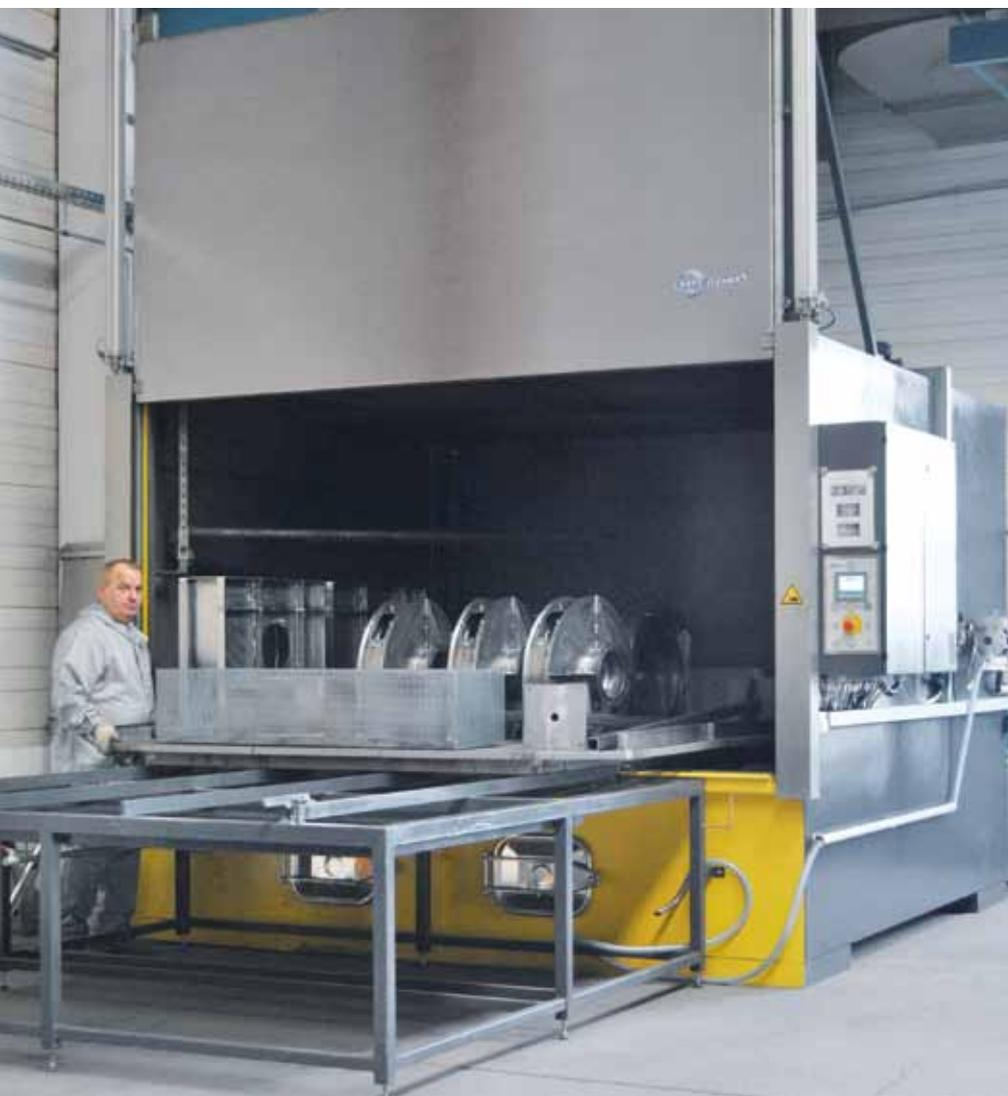
*Die Endreinigung aller Teile sowie das Entfetten vor dem Lackiervorgang erfolgen in einer BUPI-CLEANER® Einkammer-Spritzreinigungsanlage in Übergröße. Die kundenspezifischen Abmessungen erlauben die Reinigung von Teilen mit bis zu drei Metern Länge. Sämtliche Aggregate sind instandhaltungsfreundlich außen angebracht.*
